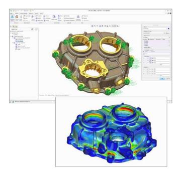
Sie können Ihr Modell analysieren und problematische Bereiche im Handumdrehen identifizieren. Nach der Aktualisierung der Konstruktion kann die Analyse einfach wiederholt werden, ohne dass eine Neuerstellung notwendig ist.
